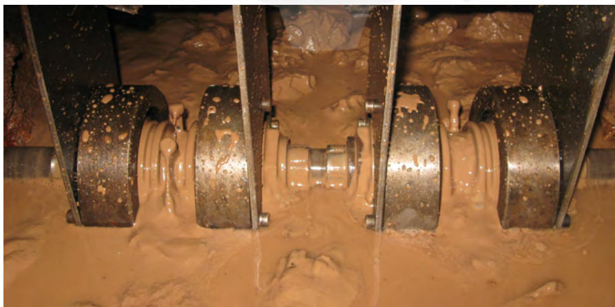
Стенд испытаний в условиях жидких загрязнений
